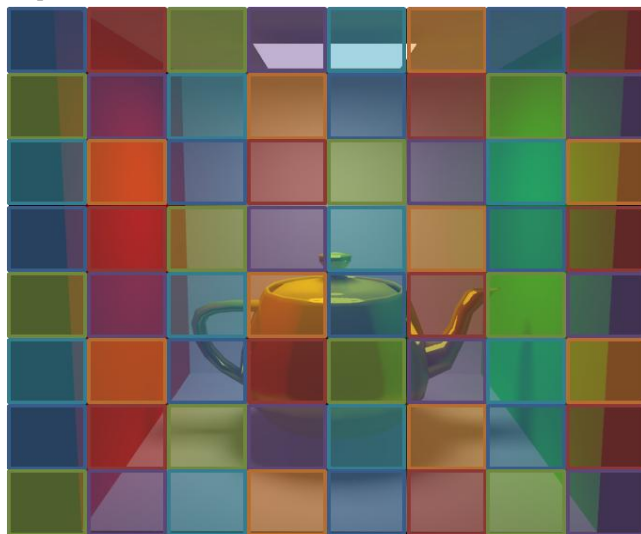
Рис. 4. Экран разделенный на блоки. Блоки одного цвета обрабатываются одним блоком потоков.
