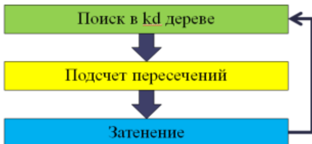
Рис. 2: декомпозиция алгоритма трассировки лучей.
