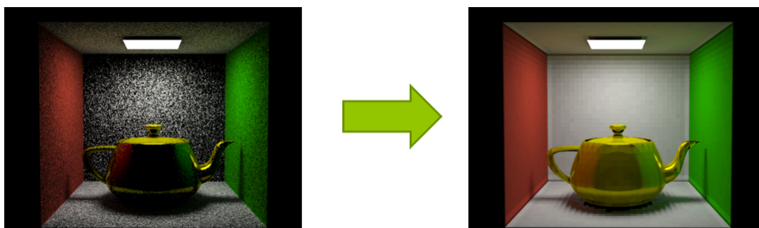
Рис. 2.15: Слишком малый радиус сбора для глобальной фотонной карты [SPPM (diffuse)] малый размер ячеек приводит к ошибкам (слева). Нормальный размер ячейки и радиуса сбора (справа).
