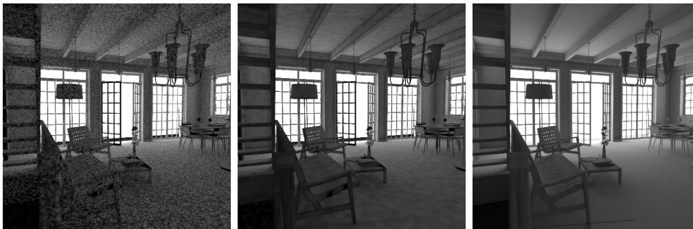
Рис. 2.10: Справа - визуализация фотонной карты, слишком маленький радиус. Центр - визуализация фотонной карт, нормальный радиус радиус. Слева - результат финального сбора.
