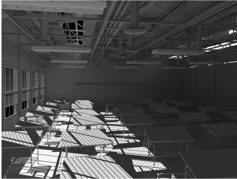
Рис. 55: Комната, освещенная солнцем через окно. Лишь \frac{1}{7} часть выпущенных из источника света фотонов попадает внутрь комнаты.
