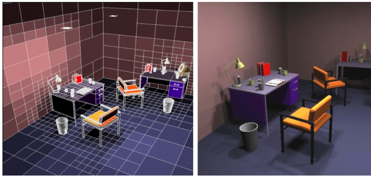
Рис. 4.2. Основная идея метода излучательности [17]. Слева показано разбиение геометрии на площадки. Справа - финальный результат расчёта освещенности. Только вторичная освещенность была рассчитана при помощи метода излучательности на данном изображении. Обратите внимание, что достаточно чёткая тень от мусорного ведра на правом изображении представлена всего 4 площадками на левом изображении.
