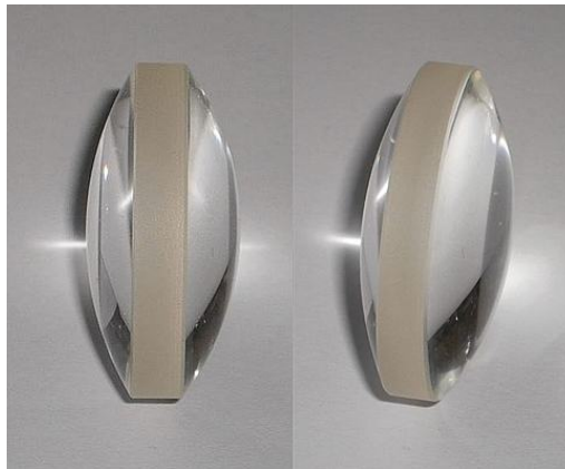
Рис. 5.14. Фотография настоящей линзы. Хорошо видно что линза имеет 2 поверхности и ненулевую толщину.
