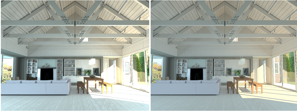
Рис. 3.5. Слева пример синтеза без использования алгоритма тональной компрессии. Справа пример синтеза с использованием алгоритма тональной компрессии.
