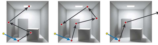
Рис. 7.5. Иллюстрация алгоритма трассировки путей. Корректный перенос света моделируется путем просчета большого числа путей.
