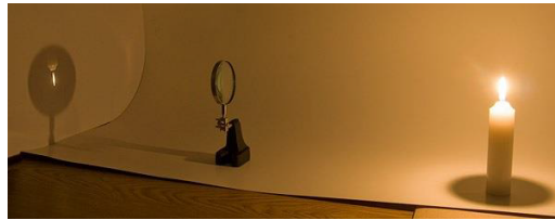
Рис. 5.17. Изображение в линзе переворачивается.
